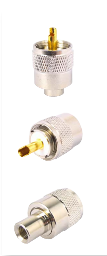
PL-259/6 kurz PTFE mit Gold-Pin PL-Stecker für RG-58U, 6 mm CB6206
